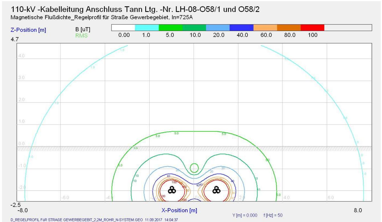
Magnetische Flußdichte (n) Fall System:  $B_{max}$  ca. 4,3  $\mu T$ , maximale Dauerstrombelastung 725 A
