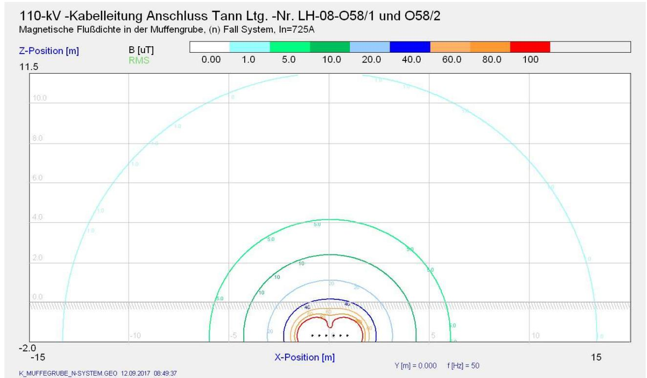
Magnetische Flußdichte (n) Fall System:  $B_{max}$  ca. 21,3 µT, maximale Dauerstrombelastung 725 A
