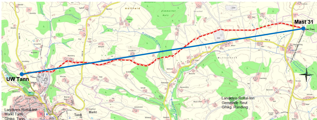
Abbildung 10: Trassenverlauf der kürzesten 110-kV-Freileitungsvariante ca. 5,5 km
