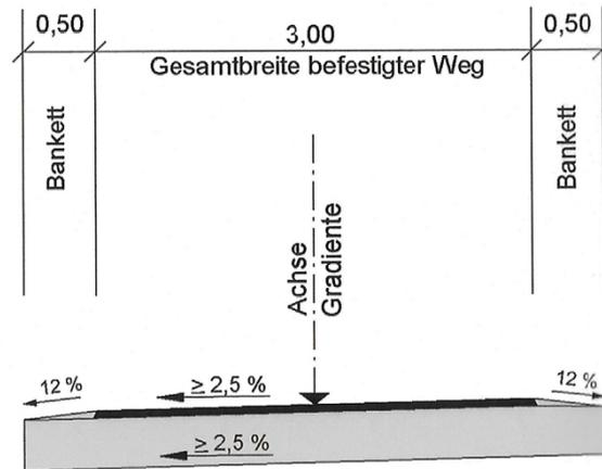
Oberbau und Deckschicht entsprechend Bestand
