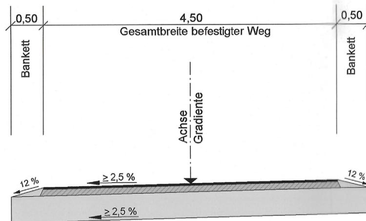
Oberbau und Deckschicht entsprechend Bestand
