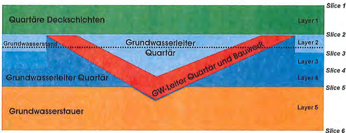
Abbildung 3: Schema des Modellaufbaus mit Einbau des Bauwerks
