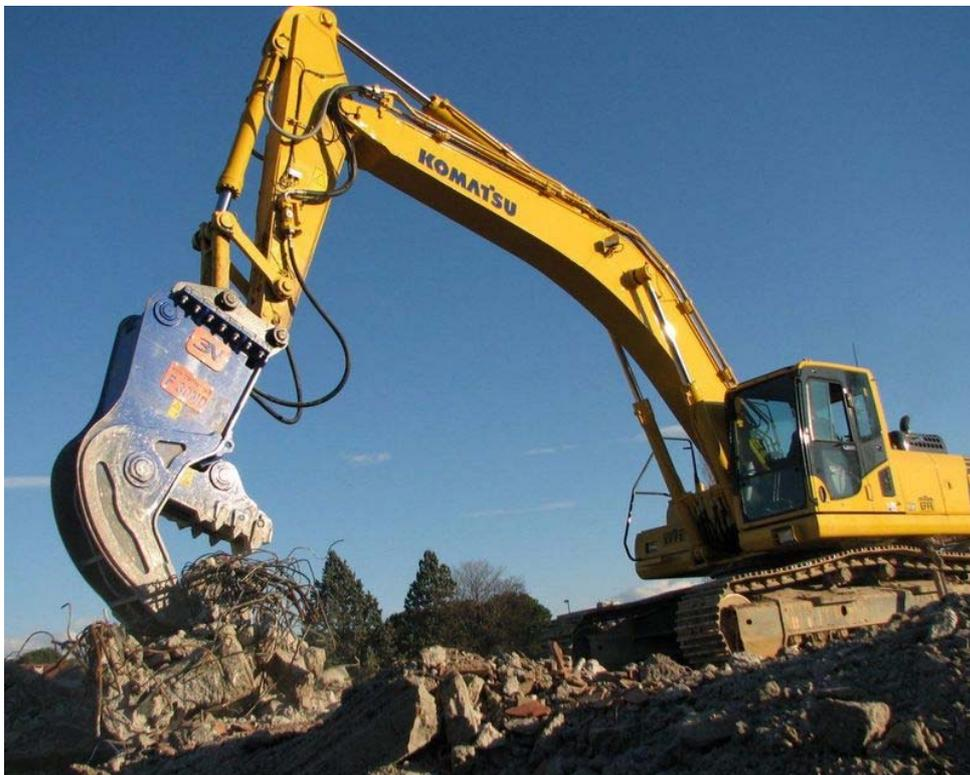
*Abbildung 2.1: Bagger mit Abbruchzange (Pulverisierer)*
